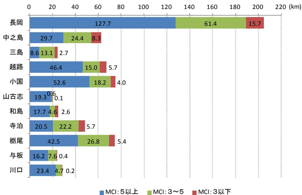
※ 「MCI (Maintenance Control Index)」とは、舗装の劣化具合を路面の「ひびわれ率」、「わだち掘れ量」、「平坦性」をもとに10点満点で評価する指標で、一般に5以上の場合は補修の必要のない望ましい管理水準とされ、3~5の場合は補修が必要、3以下の場合は早急に補修が必要とされています。
