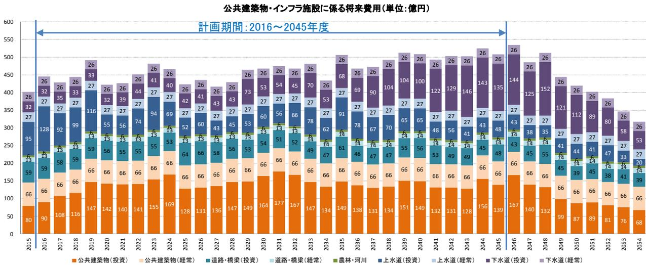
時期によって、相対的にコストがかかる分野が異なります。当初は上水道分野の割合が大きく、2020～30 年代にかけては公共建築物の割合が大きくなり、2040 年代に入ると徐々に下水道分野の割合が大きくなっていきます。道路・橋梁分野は時期による変動が小さく、常に一定割合を占めています。
