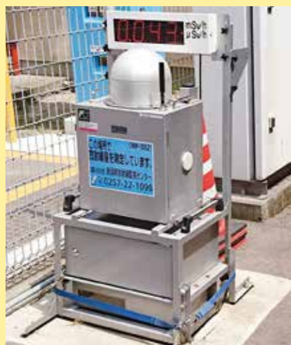
▲放射線量を測定するモニタリングポスト (市内65か所に設置) ※令和6年3月現在
