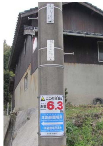
避難誘導のための標識例 (津波避難場所誘導の場合)
