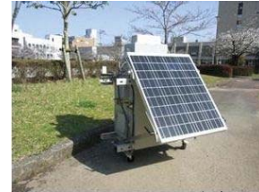
可搬型モニタリングポスト (ソーラ発電装備, 携帯電話通信機能付)
