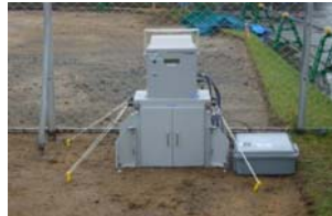
可搬型モニタリングポスト (衛星電話等による通信機能付)
