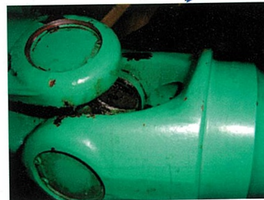
継手破損の状況
