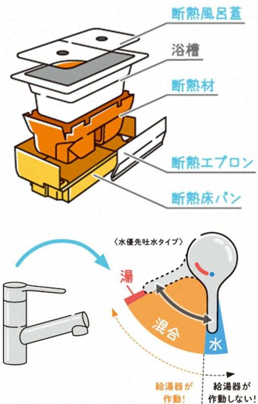
図 高断熱浴槽(上)、節水・節湯水栓(下)
