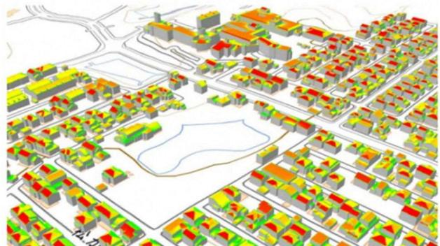
図 3D都市モデルを活用した太陽光発電のポテンシャル推計及び反射シミュレーションイメージ
