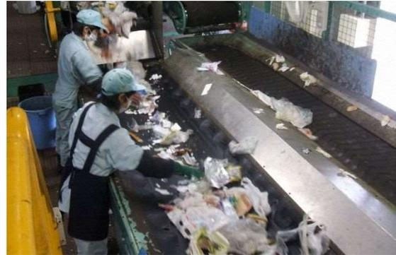
写真 プラスチック容器包装材の分別作業
