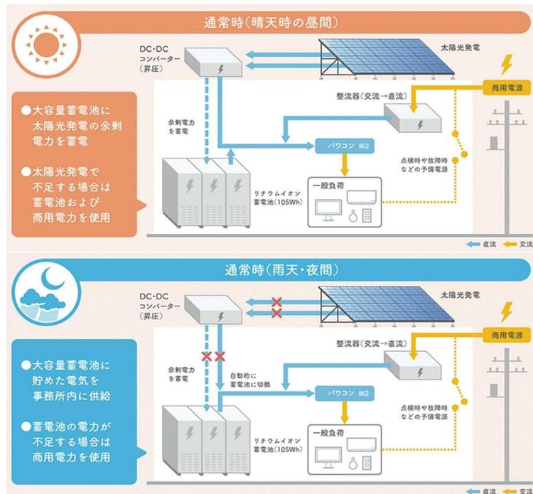
図 太陽光発電と蓄電池を連携した電力自立システム
