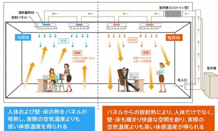
図 高効率空調機システムの例
