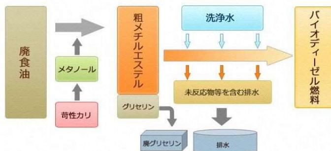
図 バイオディーゼル燃料の精製フロー(アルカリ触媒法)
