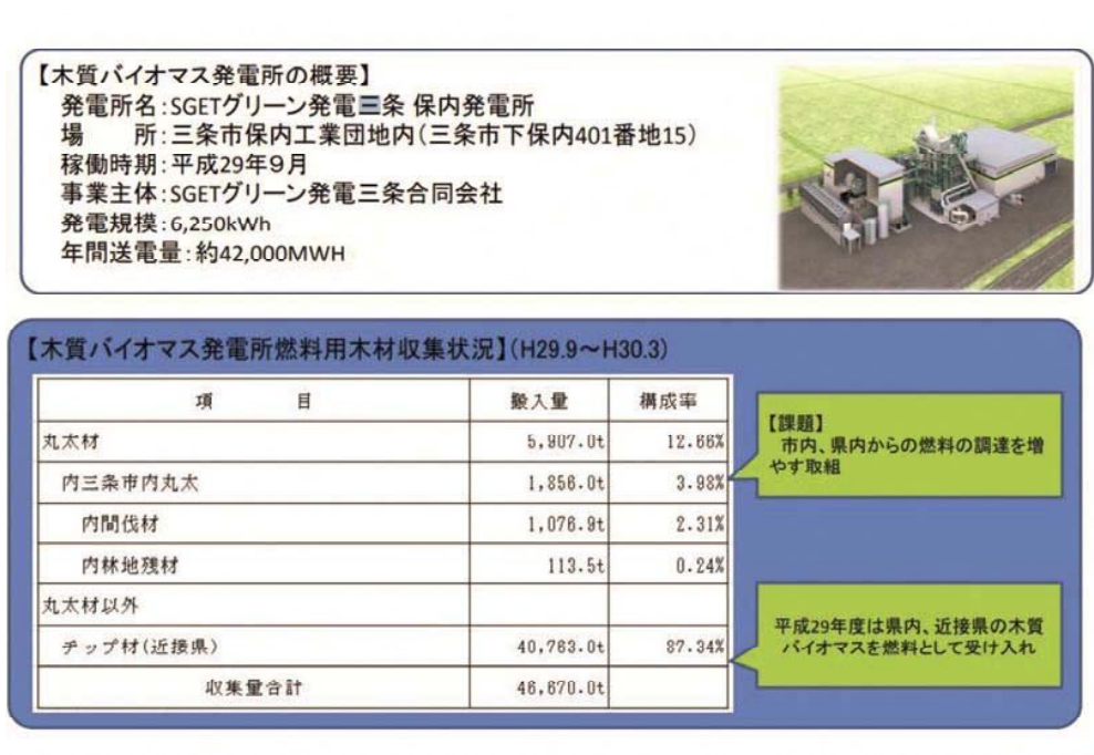
図 7 三条市の木質バイオマス発電所の概要と燃料用木材収集状況（平成 30 年度 第 1 回三条市バイオマス利活用推進会議の資料より）
