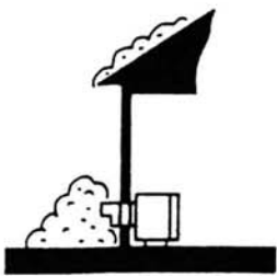
給排気筒トップ埋設
