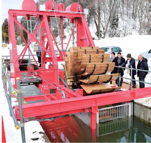
大原鉄工所の小水力発電設備の試作機 (1月29日から実証実験を開始)
