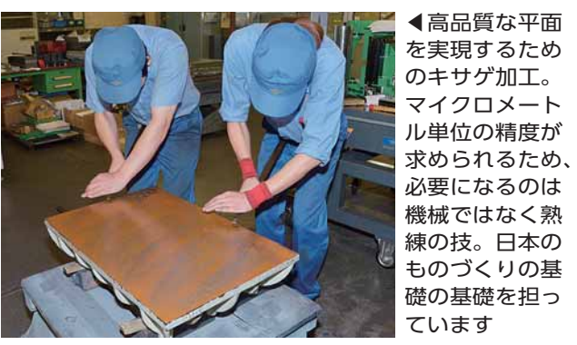
◀高品質な平面を実現するためのキサゲ加工。マイクロメートル単位の精度が求められるため、必要になるのは機械ではなく熟練の技。日本のものづくりの基礎の基礎を担っています
