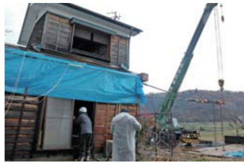
▲市が行った木造住宅の引き倒し実験で、耐震補強の有効性が実証されました
