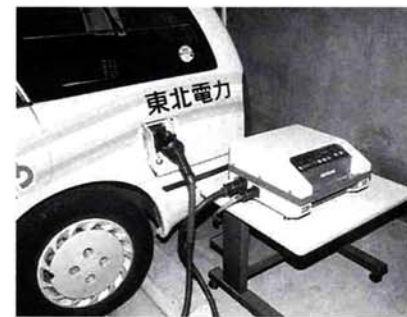
◀ポータブルタイプの充電器で、充電を行います。充電時間は約5時間。車種や走行条件によっても違いますが、この車の場合、1回の充電では、時速40キロだと160キロメートルまで走行が可能です。
