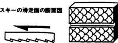
滑走面のギザギザになった部分が雪をつかまえてくれるので滑らずに登っていける
