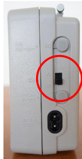
受信機横電源位置
